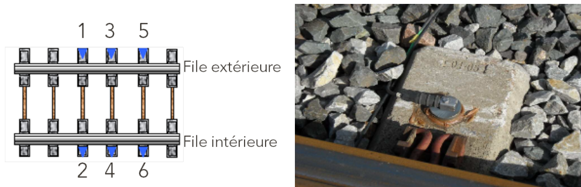
FIGURE 4.4 : A gauche : position des accéléromètres (identique pour chaque zone). A droite : photo d'un accéléromètre pendant les mesures.
