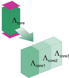
$$[\mathbf{\Lambda}_{\text{core}}] = \begin{bmatrix} [\mathbf{C}_1] & \mathbf{0} \\ \frac{(3+\alpha_1) \cdot G_{yz}^0}{4} & 0 & 0 \\ \mathbf{0} & 0 & \frac{(3+\alpha_2) \cdot G_{xz}^0}{4} & 0 \\ 0 & 0 & 0 & G_{xy} \end{bmatrix} \quad (3.17)$$
